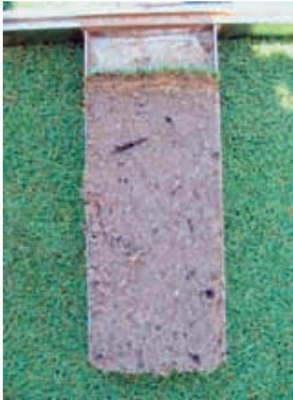
Abb. 2: Profilbild auf Golfgrün etwa 1 Jahr nach Einbau und Ansaat mit oberflächlicher Rasenfilzschicht.
